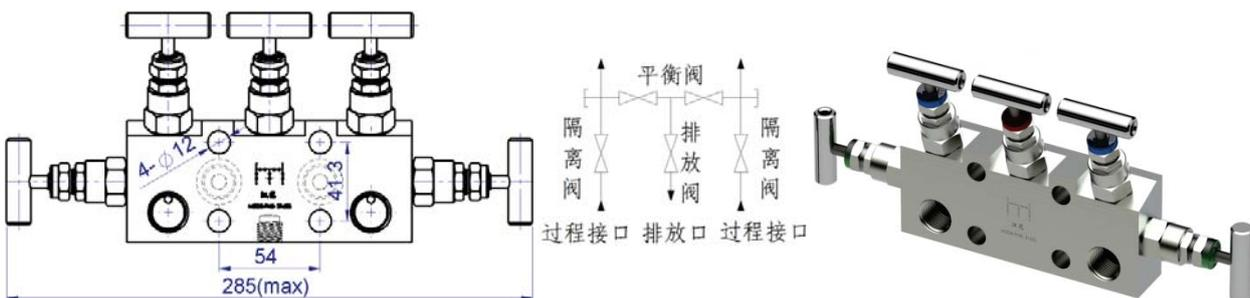
该五阀组设有两只平衡阀，适用于测量精度要求高的场所
