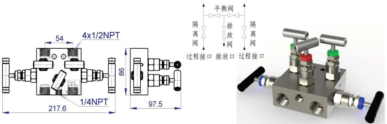
该五阀组设有两只平衡阀，适用于测量精度要求高的场所。
